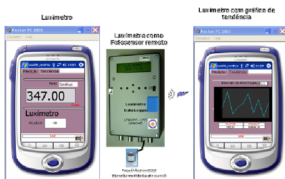
Figura 1: Luxímetro digital projetado e protótipos de interface para os modos de operação luxímetro e datalogger com gráfico de tendência.
